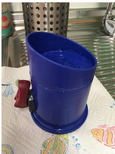
Conjunto terminado durante la prueba de estanqueidad. Se ha rellenado de agua hasta rebosar, comprobando el perfecto cierre del “tapón de vino”
