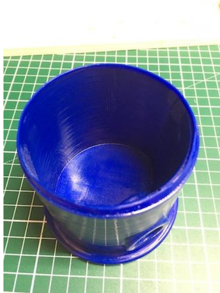
Pieza inferior, lado opuesto al orificio de limpieza. Este lado no presenta inclinación
