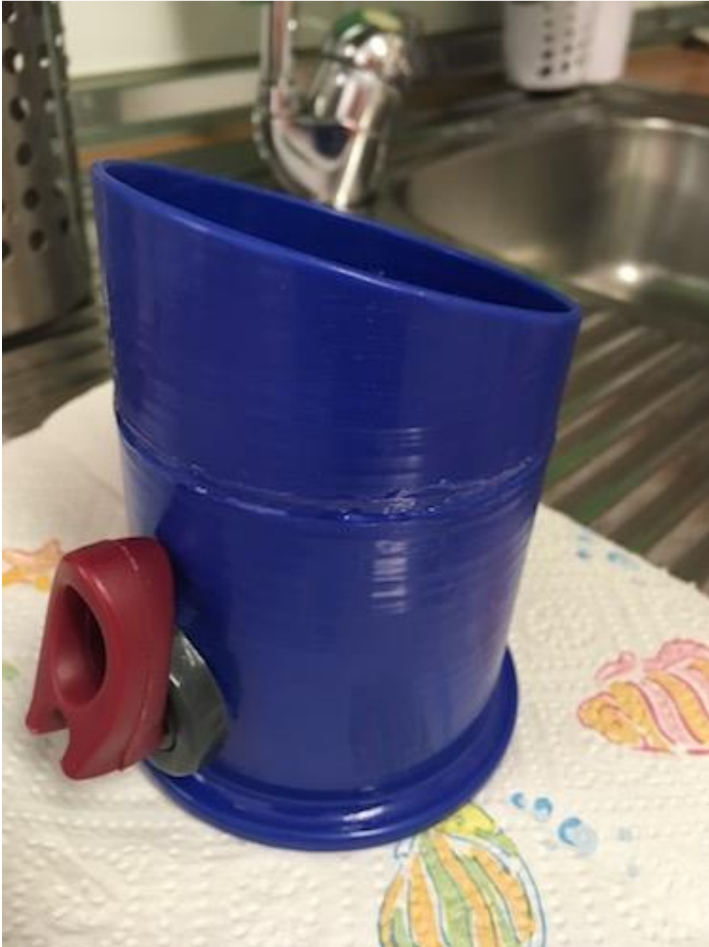
Conjunto terminado durante la prueba de estanqueidad
