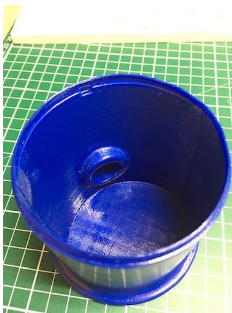
Orificio de limpieza simulando la boca de una botella de vino.
