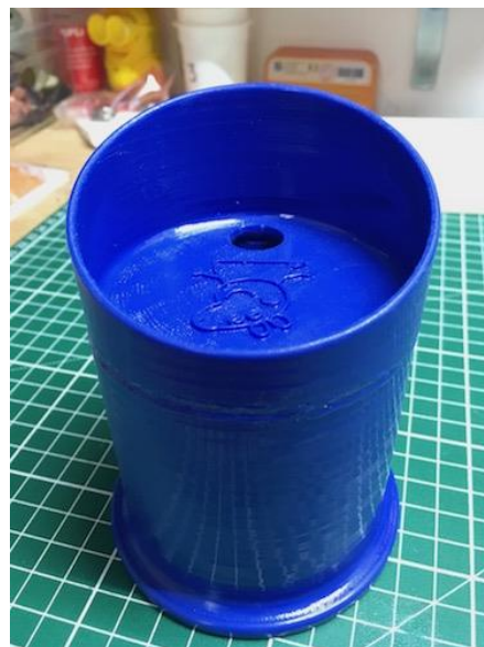
Conjunto completo, ya pegadas las 2 partes. Vista trasera. Puede apreciarse la escotadura para poder observar el flujo de líquido desde el exterior
